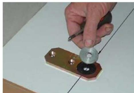
1. Maschine auf die Grundplatten montieren. Stellen Sie die Vertikalität mit den Fußschrauben ein. Verwenden Sie eine Wasserwaage.
