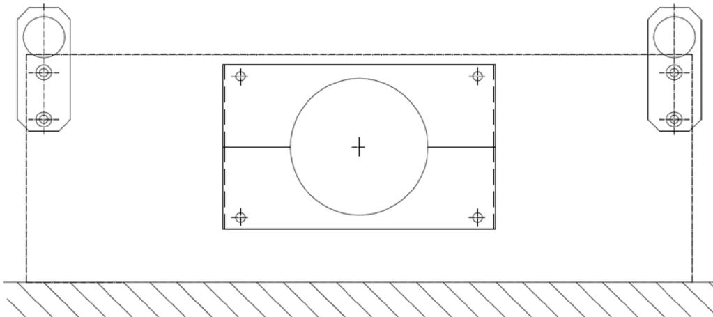
Bohren Sie die mit der Schablone markierten Löcher. Legen Sie die Wandanker in die Löcher.
